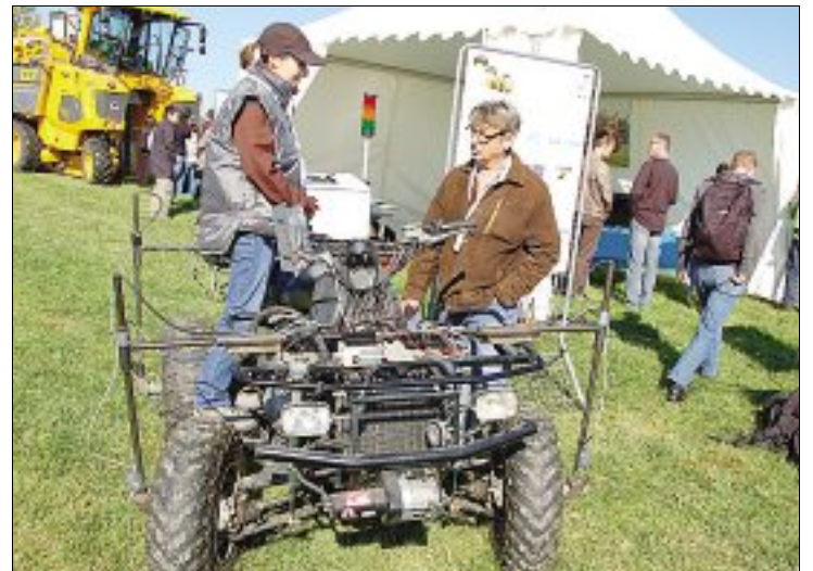
EXPÉRIMENTAL. S'il y a un transfert de charge important sur un côté de ce quad, la vitesse diminue automatiquement pour éviter le retournement.
